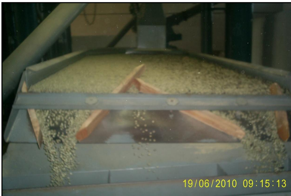
Foto 2 - Empresa Cocari no Município de Campo Alegre (GO). Máquina de beneficiamento de café, separando café de exportação do café de consumo interno. Vaneza Aparecida de Cubas. (fotógrafa), junho de 2010.
